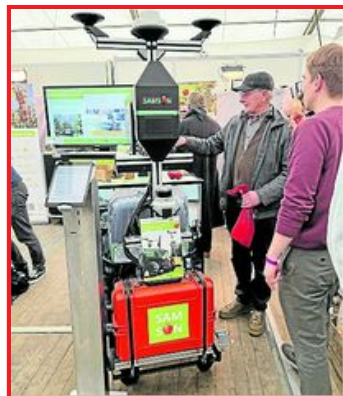
Mit dieser orangefarbenen Sensorbox lässt sich die Blühstärke der Obstbäume erfassen. Wie KI hier unterstützt, erklärt Moritz Hentzschel im Rahmen seines Impulsvortrags (siehe oben).
